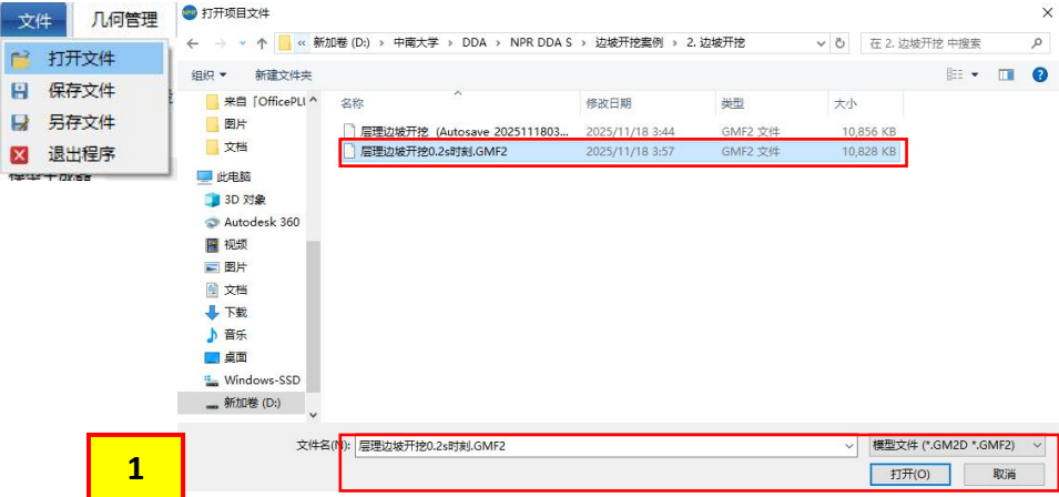
导入层理边坡开挖0.2s时刻的.GMF2文件
